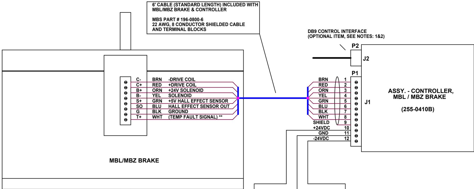
6' CABLE (STANDARD LENGTH) INCLUDED WITH MBL/MBZ BRAKE & CONTROLLER
